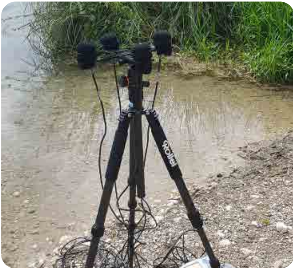
Photographie de : © Thierry LENGAGNE Antenne-micros utilisée pour la méthode de localisation de source acoustiques lointaines
